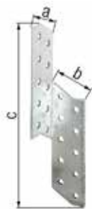
Rys. wykonanie prawostronne
